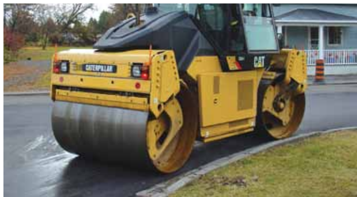
裂筒压路机可对转弯半径进行压实，而不会使新沥青出现裂缝。
