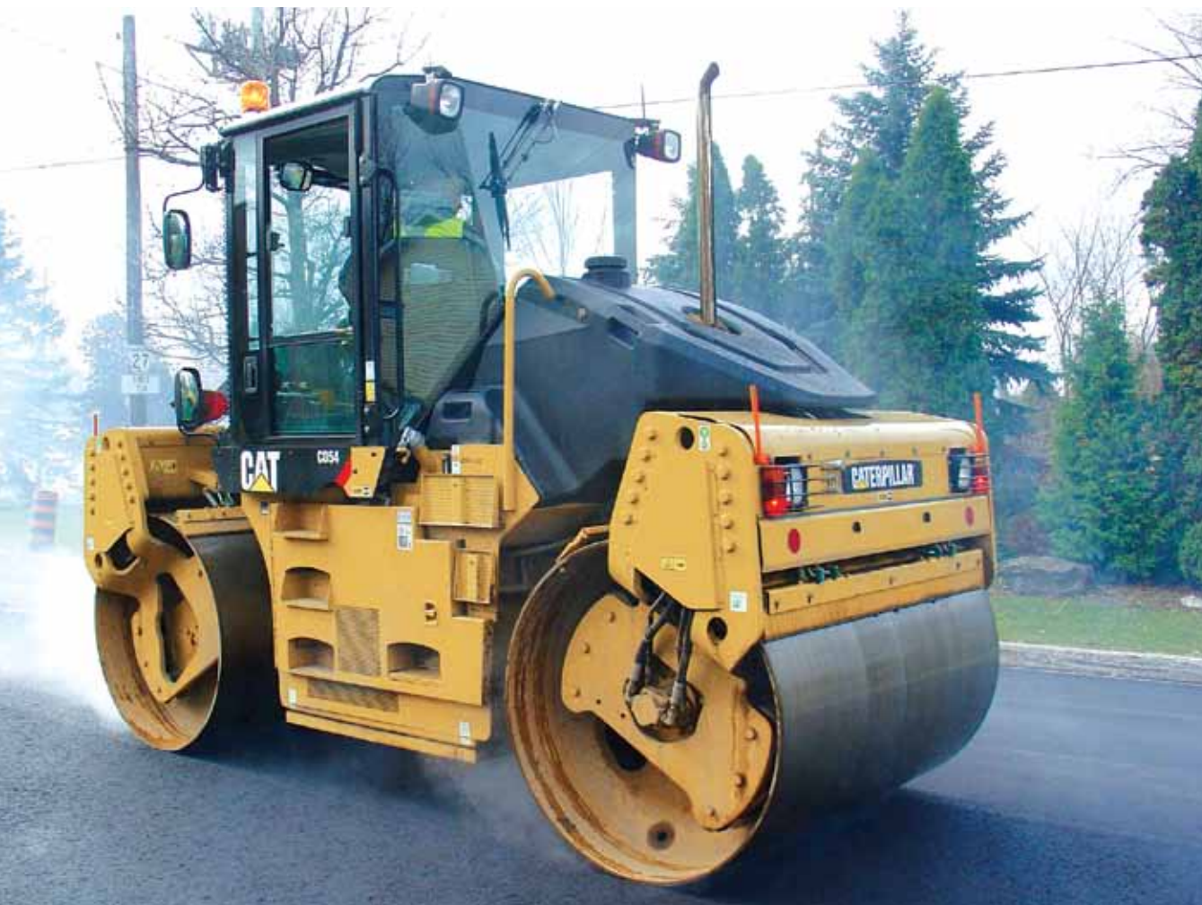
Cat CD54 在压实的初始阶段进行作业。
