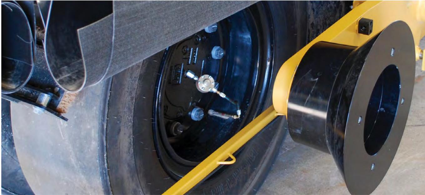
*La opción de inflado en movimiento (“air-on-the-run”) permite que sea más fácil ajustar la presión de aire en los neumáticos*
