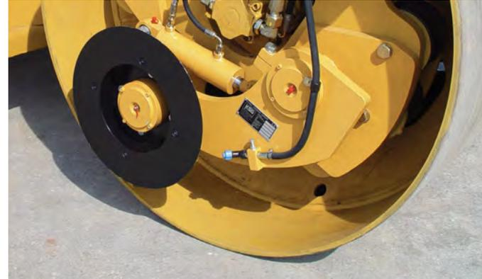
*Se crea un borde vertical no confinado al utilizar la compuerta lateral en posición flotante y haciendo contacto con la superficie de referencia*
