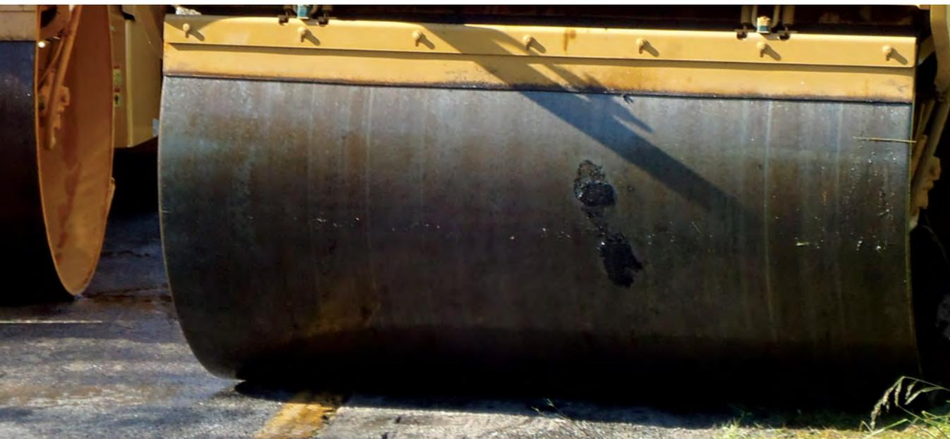
*Adherencia de material al tambor de acero, concreto asfáltico de material granular hecho con cemento asfáltico modificado utilizando polímeros*
