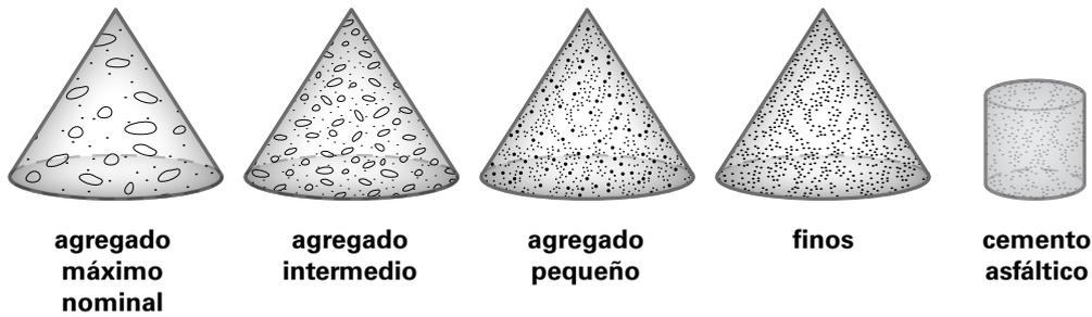
Las mezclas de granulometría densa o pesada con frecuencia se clasifican como gruesas o finas. Las mezclas gruesas tienen un tamaño máximo de agregado de 19 mm (3/4") o más. Las mezclas gruesas generalmente se tienden en capas más gruesas, de 75 mm (3") o más.
