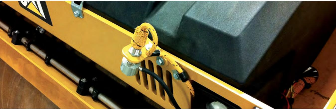
*Sensores infrarrojos envían los datos de las temperaturas a la pantalla dentro de la cabina del operador.*
