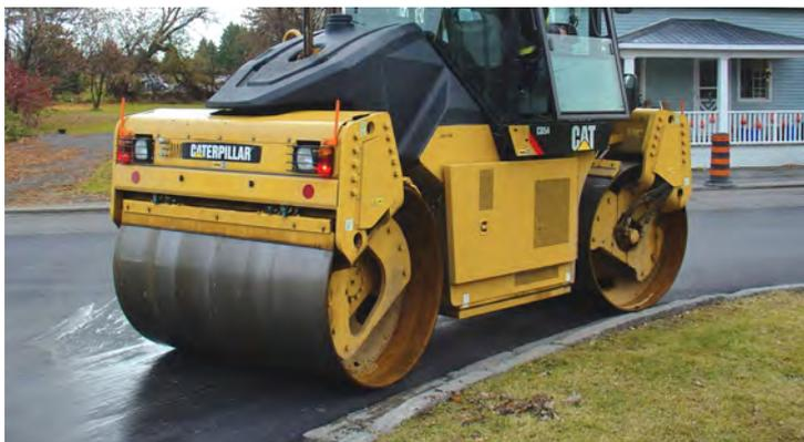
*Los compactadores con tambor dividido pueden compactar áreas radiales sin romper el asfalto fresco.*
