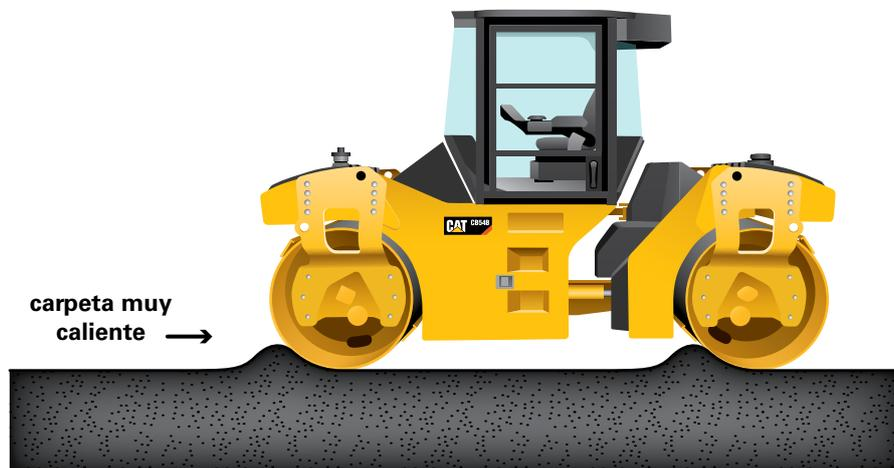
Casi toda, si no es que toda, la densidad requerida en la capa asfáltica, debe lograrse para cuando la carpeta se enfría hasta 90 °C (190 °F). A esta temperatura el asfalto se hace tan rígido que ya no es posible ningún movimiento de los agregados. Aunque se podrían limpiar algunas marcas de la superficie de la carpeta, no es probable que se logre densidad adicional. Si la carpeta se está enfriando antes de lograr la densidad requerida:
