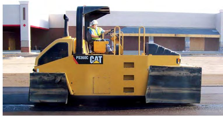
*Los faldones de los neumáticos son muy importantes en los compactadores de neumáticos y deben instalarse para ayudar a evitar la pérdida de calor en los neumáticos de goma.*
