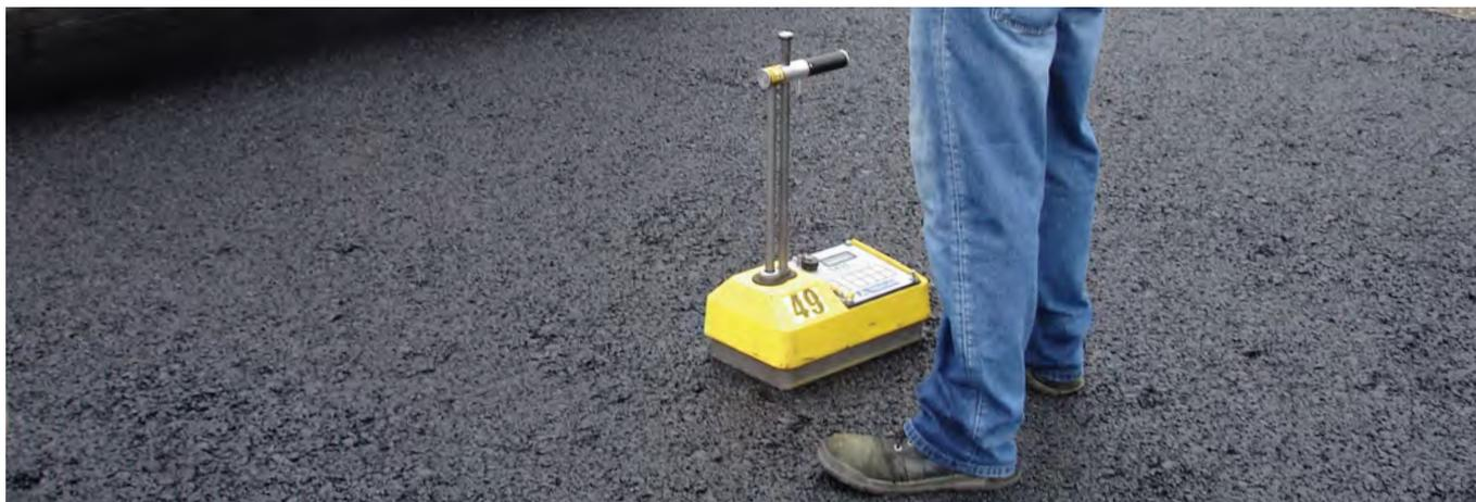
Se debe verificar la densidad de la carpeta asfáltica que tendió la regla antes de iniciar el proceso de compactación. Es muy útil saber la densidad tendida por la regla para seleccionar la amplitud y el número de pasadas necesarias para obtener la densidad requerida.
