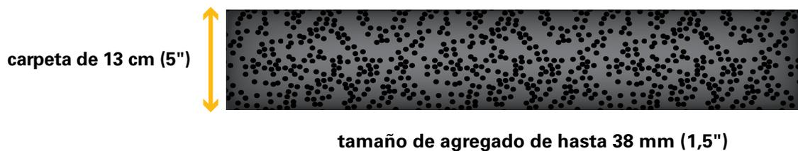
*A las mezclas de granulometría graduada con agregado grueso se les llama mezclas gruesas.*
