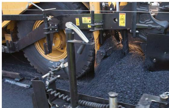
*Los sensores mecánicos o sónicos tienen la misma precisión si se usa la línea de referencia del patín como guía.*
