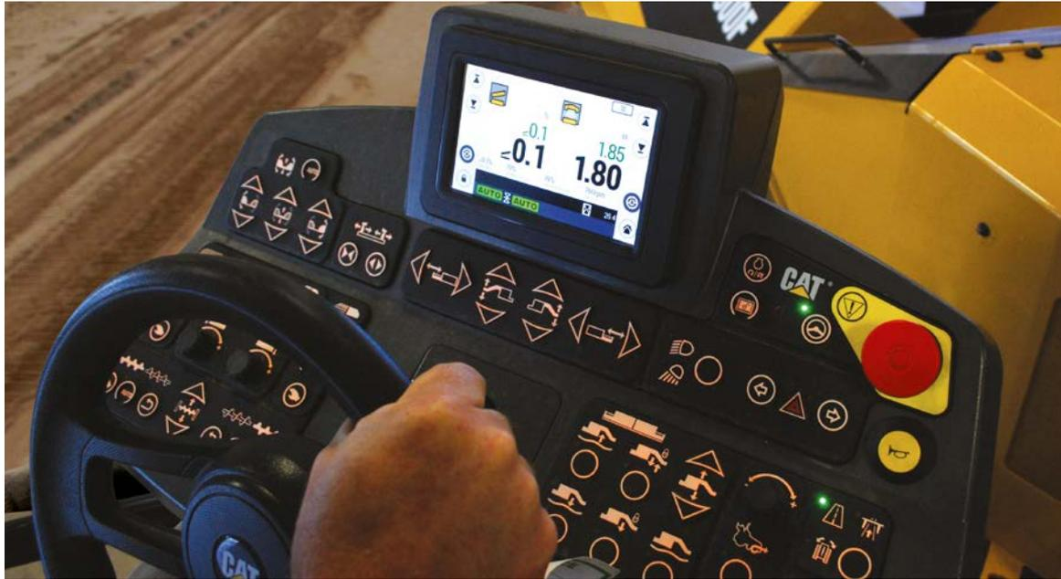
Control de nivelación longitudinal de Cat en pavimentadoras serie F.
