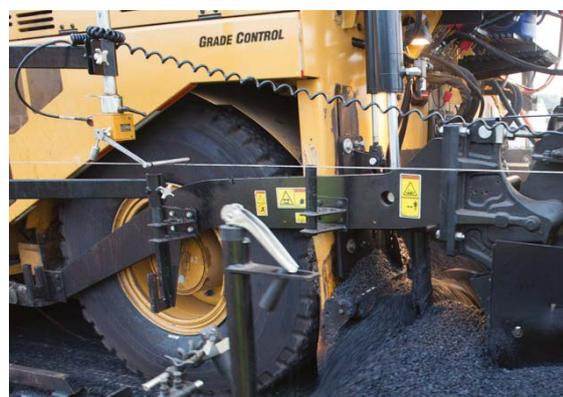
*El sensor mecánico se puede equipar con una varilla que trace una línea de referencia sobre el patín promediador.*
