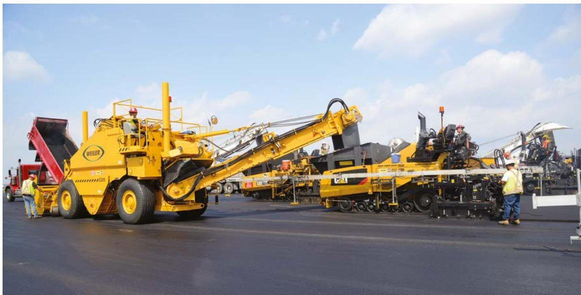
*Un vehículo de traslado de material no toma contacto con la pavimentadora ya que traslada el material de la unidad de transporte.*
