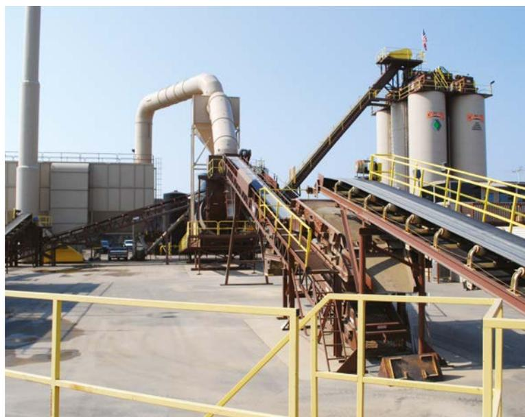
*El sistema de alimentación está diseñado para proporcionar un flujo constante de agregados al mezclador.*
