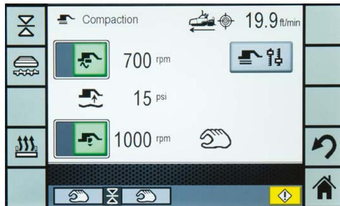
En el panel de control de la regla principal, configure la velocidad de la barra tamper en 1200 RPM con el dial multifunción. Configure el control del tiempo de rampa en la posición mínima. Configure el control de frecuencia de vibración en 1500 RPM.
