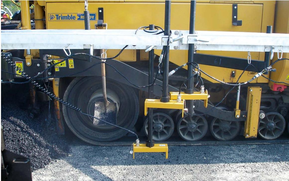
*Patín promediador sin contacto de Cat con las secciones finales plegadas y configurado para utilizar solo el sensor central para una aplicación de sensor individual.*
