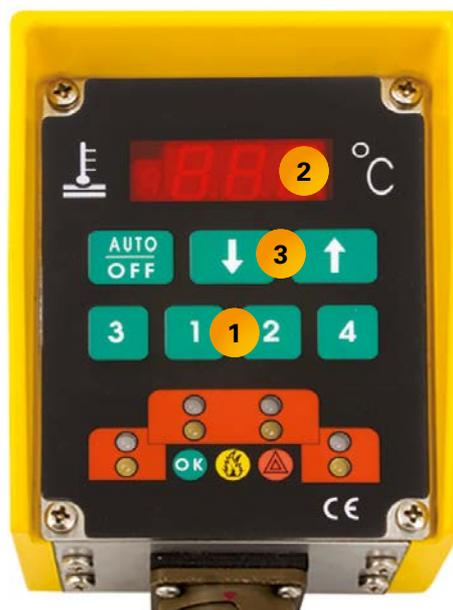
Cuando una parte de la placa de la regla está cerca de la temperatura del valor de ajuste, se encienden los indicadores correspondientes verde y amarillo. Cuando se alcanzó la temperatura del valor de ajuste, el indicador amarillo se apaga y el indicador verde permanece encendido. Cuando se encienden los cuatro indicadores verdes, la regla está lista para pavimentar.
