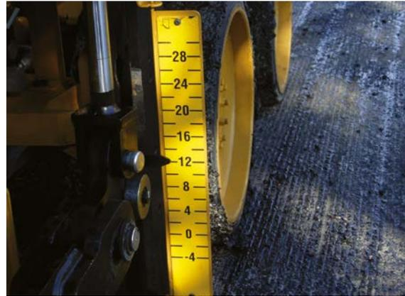
*La conexión de los puntos de remolque cuenta con una escala de altura que permite a los operadores del tractor y la regla configurar y verificar la posición de la conexión.*
