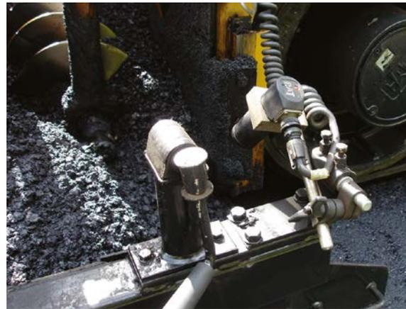
Los sensores de alimentación sónicos emiten pulsos sonoros que rebotan del material que sale de la cámara del sinfín y regresan al sensor.
