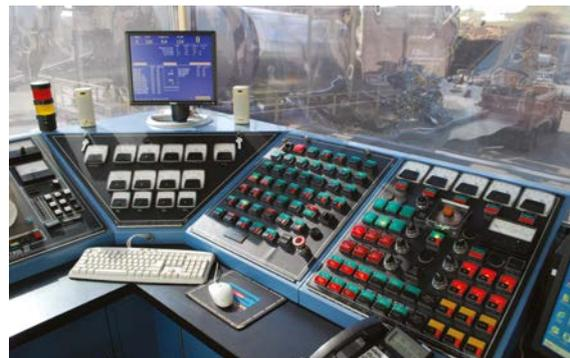
monitorear simultáneamente la producción de la mezcla, el almacenamiento de la mezcla y el funcionamiento de la balanza del camión.
