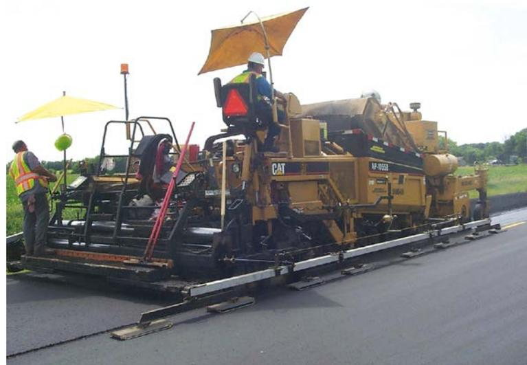
*Capa adyacente promediadora del nivelador exterior multiarticulado de 9 metros (30') de Cat mientras iguala la junta longitudinal.*
