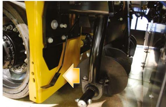
*Los sensores de paleta proporcionan un control preciso y son fáciles de ajustar con un dispositivo de medición.*
