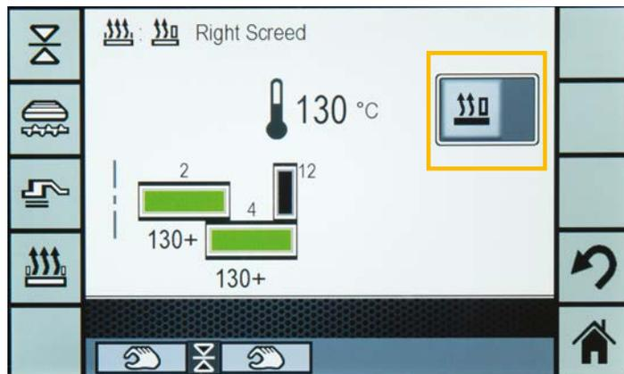
Al regresar a la pantalla de calentamiento de la regla, esta muestra el estado de varios elementos de calentamiento.
