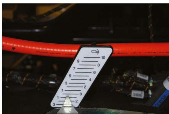
**Consejo para el usuario:** Es posible que la escala no siempre se pueda calibrar exactamente de acuerdo con la inclinación del extensor. Siempre verifique la inclinación transversal de la capa directamente detrás del extensor después de apartarse de la referencia inicial. Utilice el interruptor de inclinación para hacer ajustes a la inclinación del extensor, si es necesario.
