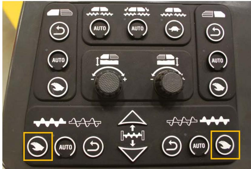
Luego, utilice el interruptor del sinfín manual para desplazar el material hacia el extremo de la regla. El nivel correcto de la cabeza de material es el que cubre la mitad de los sinfines.
