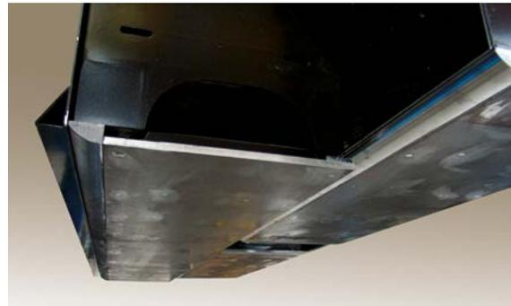
Vista de las placas de la regla en una regla extensible, vibratoria, de montaje trasero.
