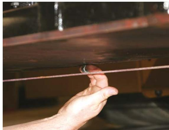
*Instalar una curvatura principal de 3 mm (0.125") en la placa principal de la regla ayuda a reducir las franjas en la línea central.*
