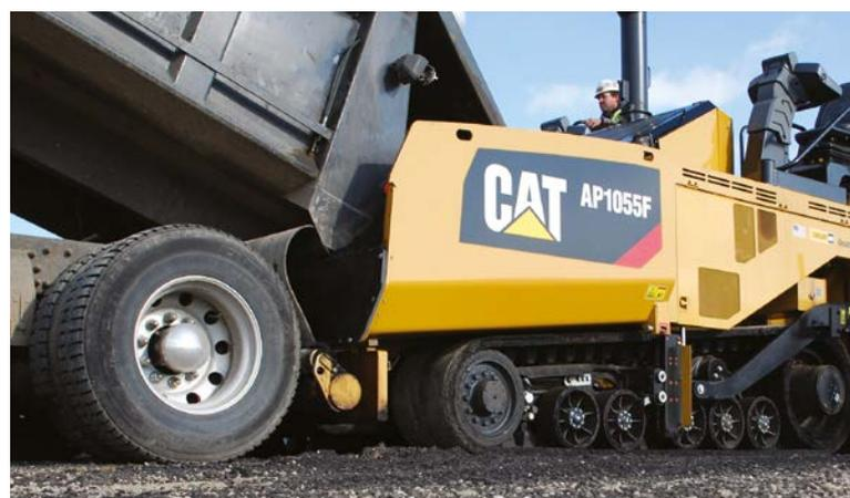
*Dos rodillos de empuje tocan los neumáticos traseros de la unidad de transporte mientras la pavimentadora empuja la unidad de transporte.*
