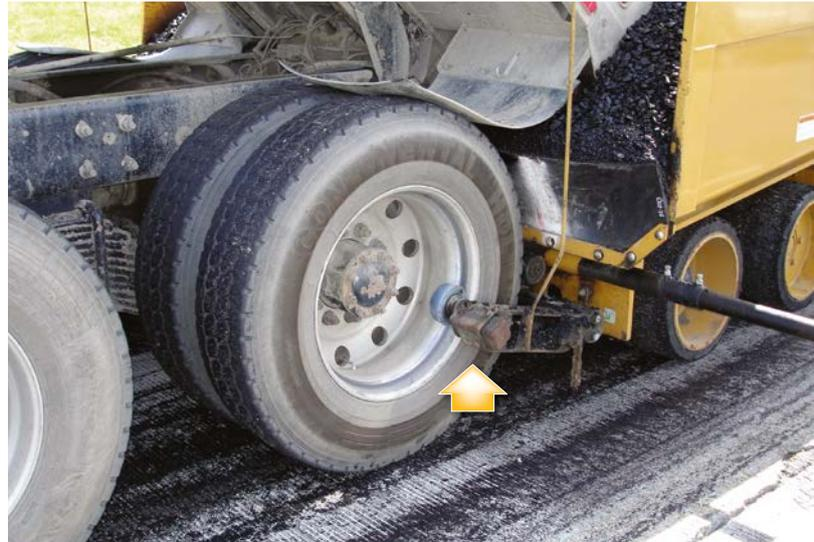
*El enganche de camión opcional ayuda a brindar una conexión segura entre el frente de la pavimentadora y la unidad de transporte.*
