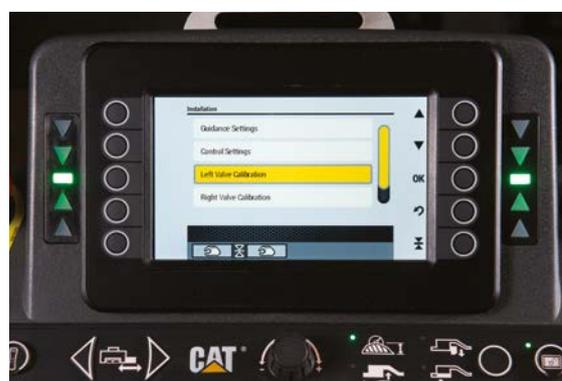
Monitor que muestra el comienzo de la calibración de la válvula del punto de remolque izquierda.
