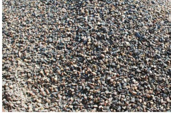
*Un tamaño y tipo consistente de agregado es esencial para configurar la pavimentadora para lograr los mejores resultados.*
