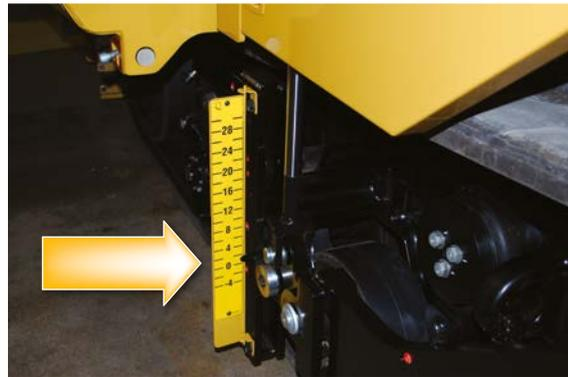
Posicione la altura del punto de remolque de manera que cree la línea de tracción correcta.
