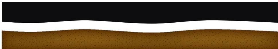
Un sistema de control tridimensional puede aceptar el factor de compactación (en este caso 1,25) y planificar el factor de compactación en el diseño. Se indicará a la regla que aumente el espesor aun más cuando se pavimente sobre baches y que lo disminuya cuando se pavimente sobre zonas elevadas del suelo. En este ejemplo, la compactación diferencial producirá una superficie más homogénea y nivelada.
