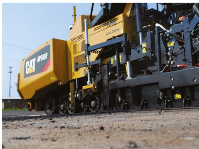
Los derrames sobre los costados de la tolva pueden terminar en el área objetivo del sensor de nivelación longitudinal.
