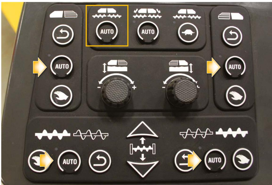
Cuando la cámara del sinfín se haya llenado hasta la mitad, ni más ni menos, coloque los transportadores y los sinfines en modo automático. Presione el botón de transportador y sinfín automáticos o los botones automáticos individuales para el transportador y el sinfín. Verifique que los cuatro indicadores del sistema automático estén iluminados.
