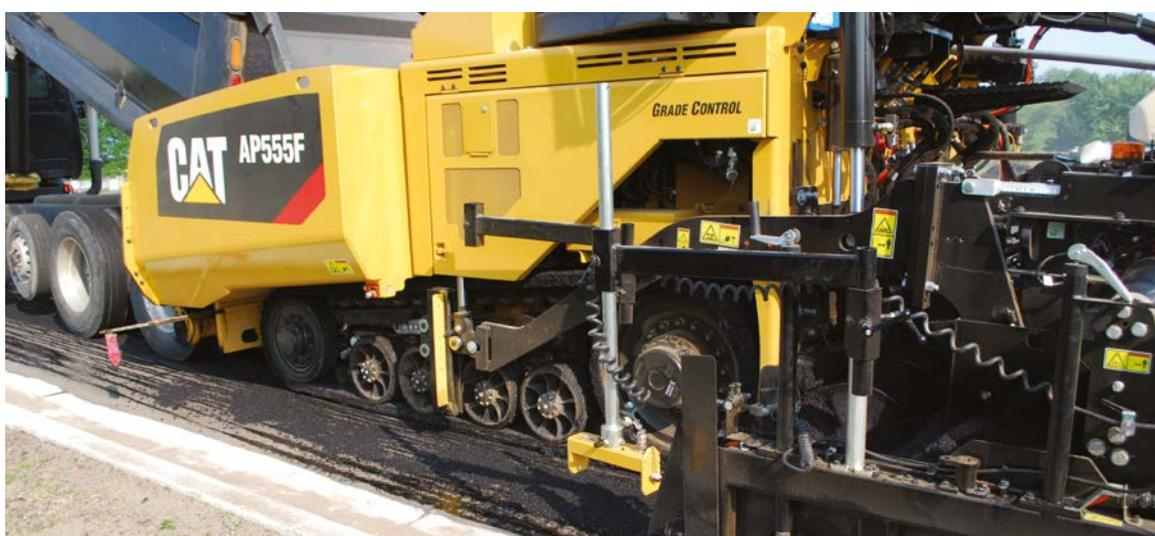
*Configure el control de nivelación longitudinal y transversal de acuerdo con los requisitos o especificaciones del proyecto.*
