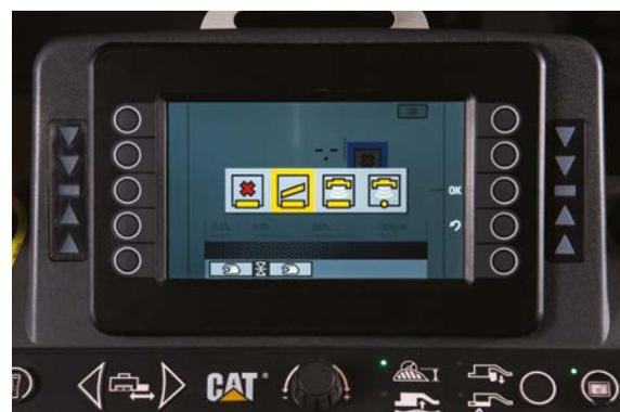
*Seleccione el control de nivelación transversal para el lado correcto de la pavimentadora.*
