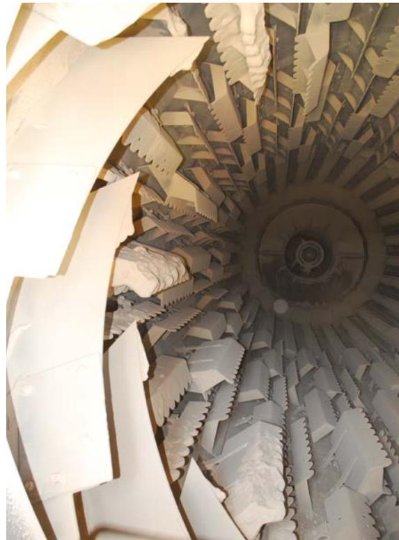
El espiral del mezclador de tambor desplaza continuamente los agregados hacia el extremo inferior.
