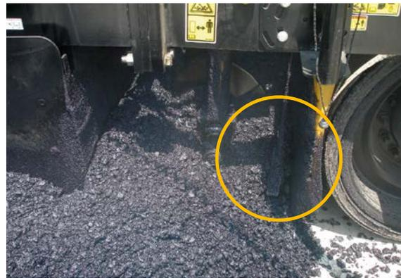
Los sensores de alimentación mecánicos toman contacto con el material a medida que fluye hacia afuera de la cámara del sinfín.
