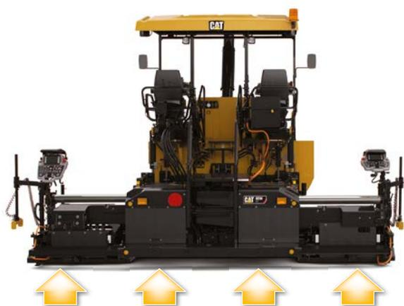
Los tableros se deben colocar en el borde externo de la regla principal (detrás del tractor) y los bordes externos de los extensores.
