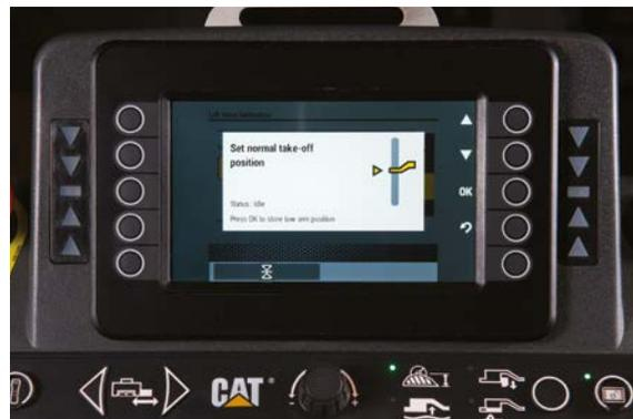
Monitor con instrucción de configurar el límite inferior del recorrido del punto de remolque.
