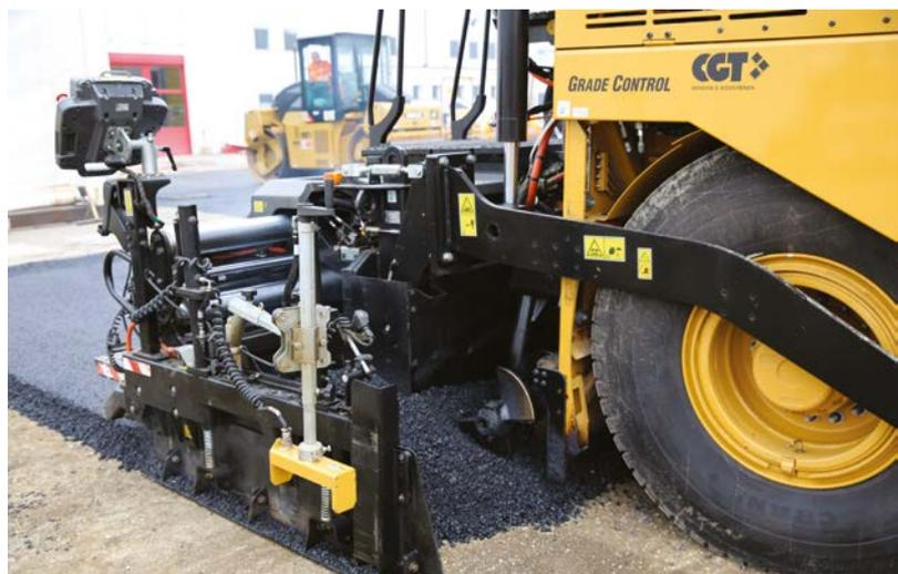
La posición del sensor de nivelación longitudinal justo delante de la cámara del sinfín ayuda a crear una reacción más rápida de la regla.
