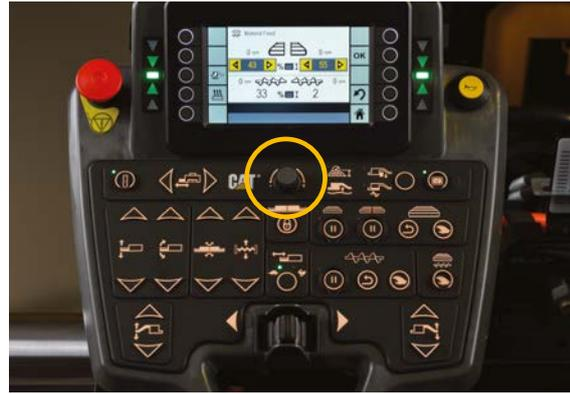
Los diales de altura de la mezcla de los paneles de control regulan la cabeza de material en los extremos de los ejes del sinfín.
