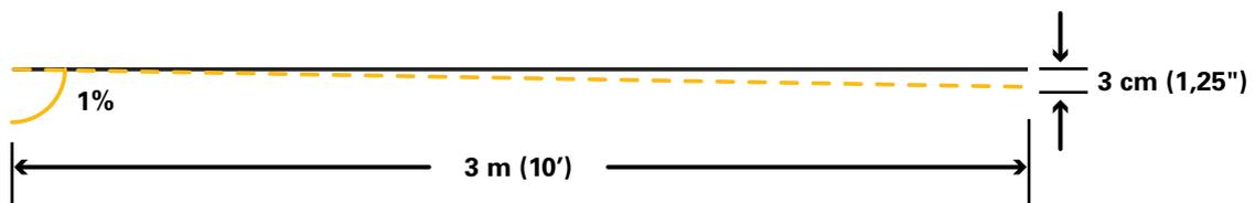
Prevea el hecho de que una estructura necesita tener una nivelación transversal del 1 por ciento de izquierda a derecha. A partir del borde izquierdo de la estructura, la elevación de la capa debe disminuir 1 cm por metro, 0,125" por pie. Si el ancho de la estructura es de 3 m (10'), el cambio de elevación será de 3 cm (1,25").
