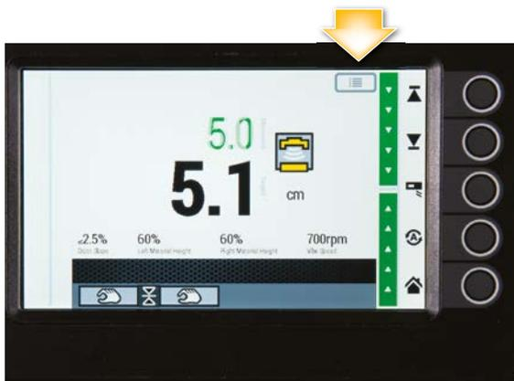
*Monitor de control de nivelación longitudinal que muestra el modo de una sola pantalla para el lateral derecho de la regla.*
