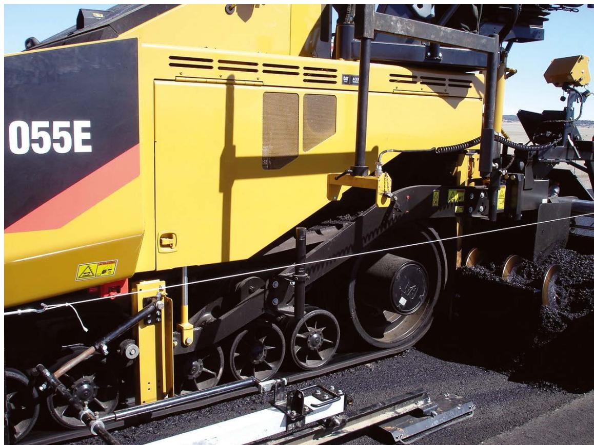
*Los sensores de nivelación longitudinal sónicos de Cat están orientados horizontalmente cuando se lee una línea de referencia.*
