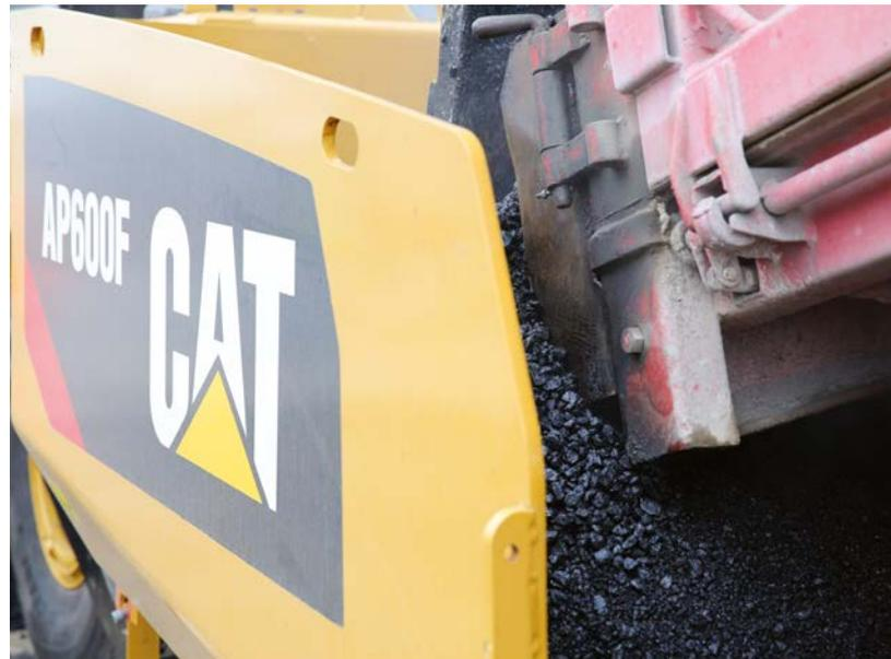
*Las acumulaciones de material a los lados de la tolva pueden interferir con la compuerta trasera del camión.*
