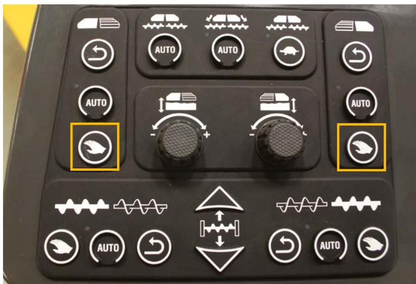
Llene la cámara del sinfín. Para ello utilice los controles manuales del transportador y del sinfín.
