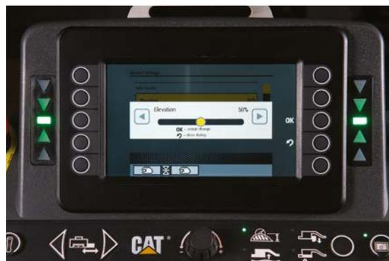
El aumento del valor de la velocidad de la válvula de elevación también acelera la reacción de la regla.
