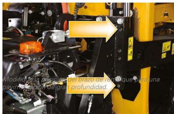
Modifique la posición del brazo de remolque para una pavimentación de gran profundidad.
