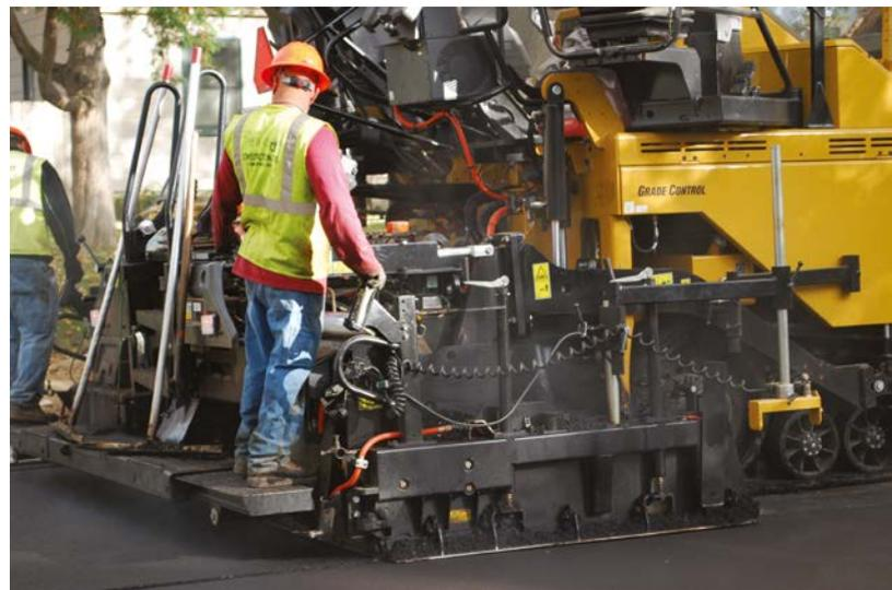
*Un sensor de nivelación longitudinal individual instalado cerca de la cámara del sinfín proporciona el mejor control de espesor de la capa y producción.*
