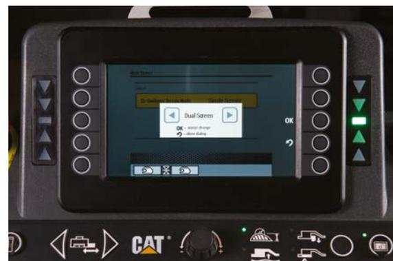
*En el menú de configuraciones del operador, un operador puede configurar el monitor de una sola pantalla o doble pantalla.*
