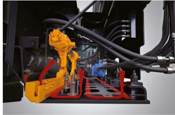
Vista de regla extensible, de montaje trasero con barras de vibración y tamper.
