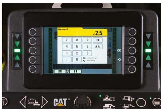
Calibre el sensor de inclinación transversal con la inclinación medida.
