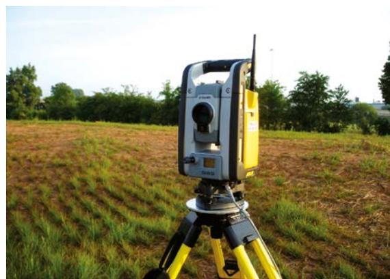
*Una estación total universal ofrece retroalimentación de guía fuera de la máquina para la pavimentadora.*
