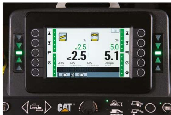
Modo de pantalla doble que muestra el lateral derecho de control de elevación (nivelación longitudinal) y el lateral izquierdo de control de nivelación transversal
