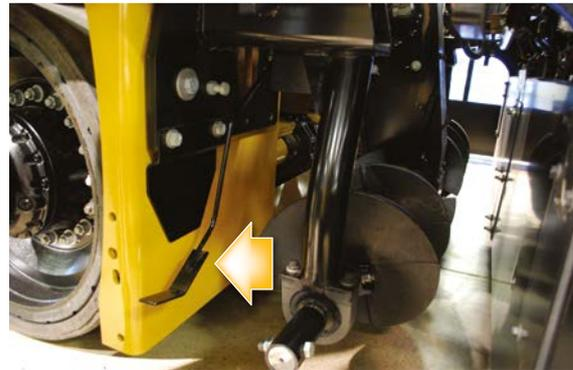
*Cuando se balancea hacia afuera en un ángulo de 45 grados, la punta de la paleta debe estar a una distancia de 45 cm (18") del último segmento del sinfín.*
