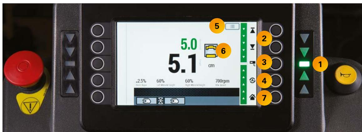
1. Los indicadores de nivelación longitudinal se encuentran en el lateral derecho más alejado del monitor. Las barras verdes se encienden cuando el sistema de nivelación longitudinal o transversal se encuentra dentro de la franja muerta. Esta condición generalmente se conoce como "en la posición a mantener". Las flechas hacia arriba y hacia abajo parpadean cuando el valor medido de inclinación longitudinal o transversal está fuera de la banda muerta.
