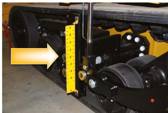
*Posicione el brazo de remolque de manera que cree la línea de tracción correcta.*
