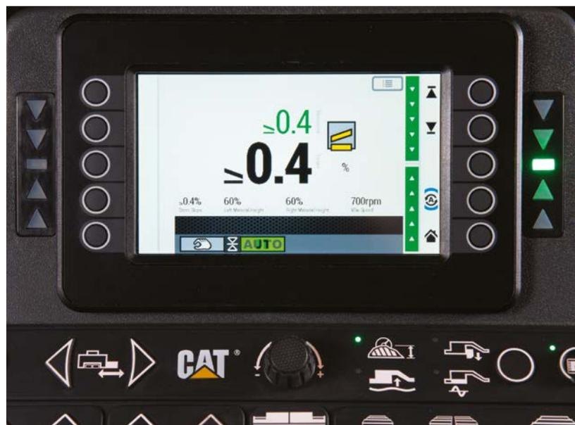
Use el monitor o la caja de control para hacer cambios en la inclinación transversal lentamente.
