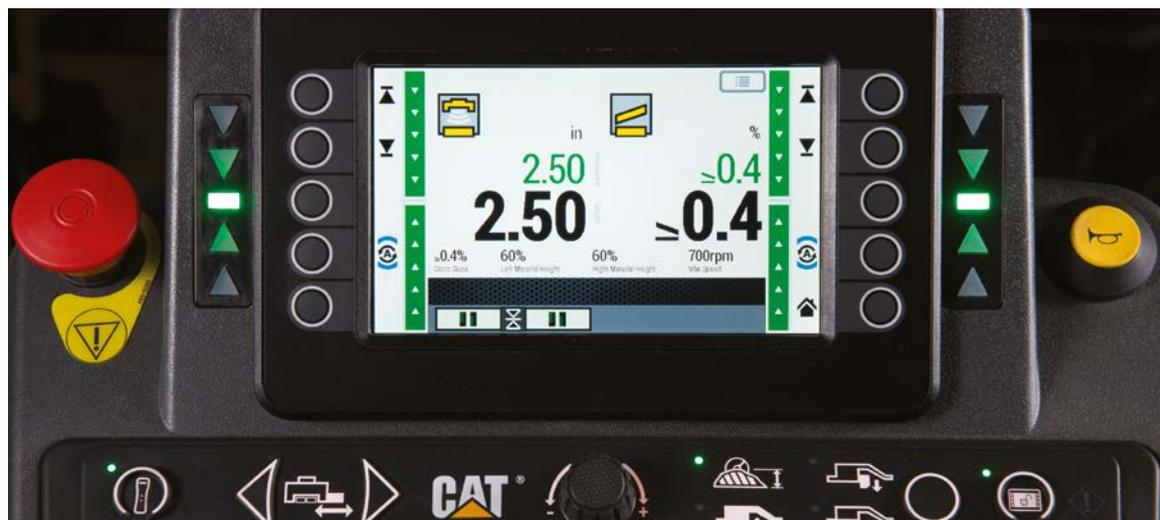
Monitor de pantalla doble con control de nivelación longitudinal del sensor individual a la izquierda y control de nivelación transversal a la derecha.
