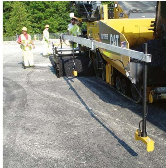
*Configuración del patín sin contacto de Cat para indicar la nivelación dentro del ancho de pavimentación.*
