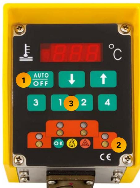
Para modificar la temperatura de cualquier quemador, pulse el botón **(1)** que corresponde al número de ese quemador. La temperatura del valor de ajuste para el quemador seleccionado se muestra en la pantalla **(2)**. Pulse las flechas hacia arriba o hacia abajo **(3)** hasta que la temperatura del valor de ajuste aparezca en la pantalla. Repita la secuencia para los otros quemadores, si es necesario.
