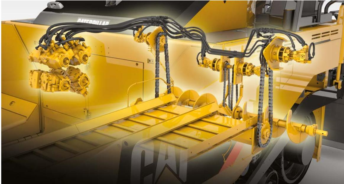
*Los transportadores del sistema de alimentación izquierdo y derecho trasladan el material hacia el frente de la regla. Los sinfines izquierdo y derecho mueven el material hacia afuera hasta el ancho de pavimentación completo.*
