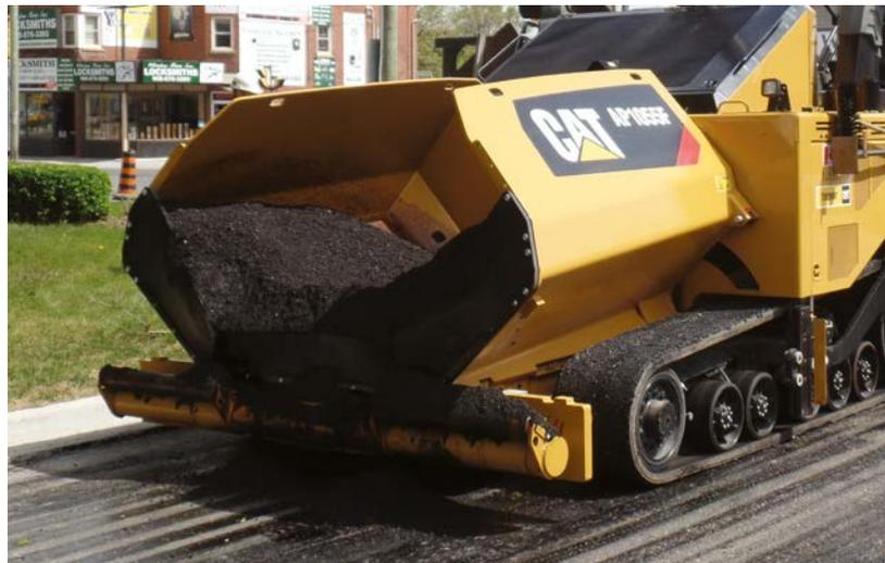
*El operador puede elevar los lados de la tolva, si lo desea y está permitido, para trasladar la mezcla desde los lados de la tolva hasta los transportadores del sistema de alimentación.*
