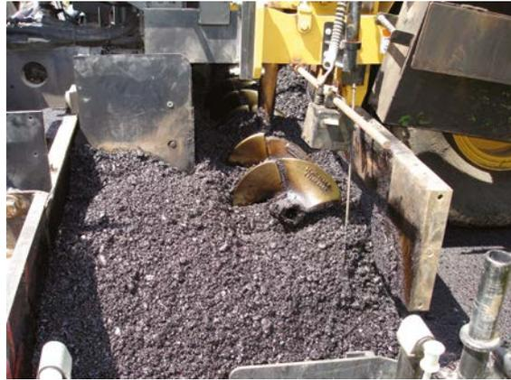
*Un personal bien capacitado configuró el sistema de alimentación para mantener la cabeza de material (la cantidad de material) correcta.*
