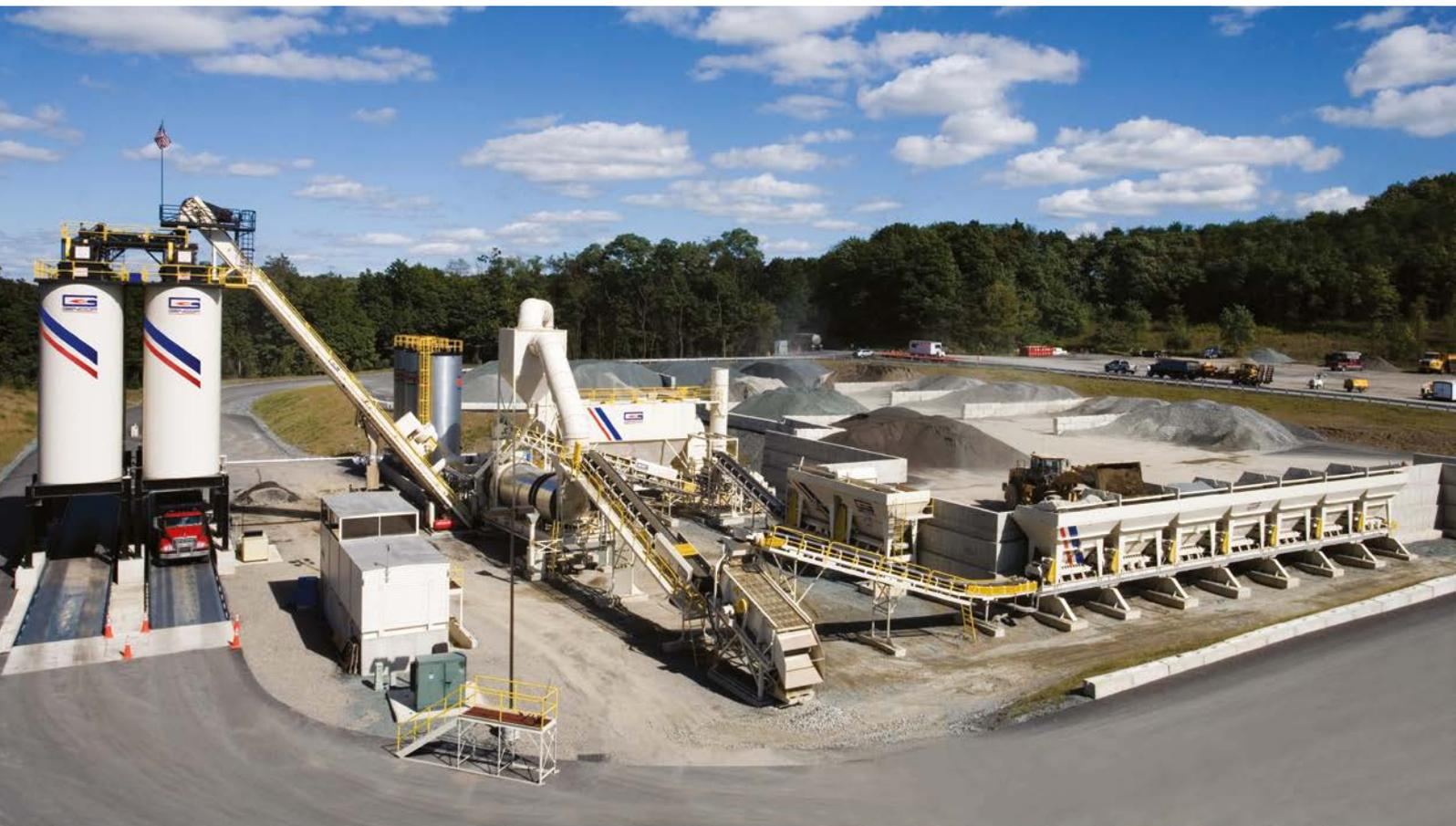
Según el diseño del centro de fabricación de asfalto, las reservas generalmente se crean de tres maneras: con transportadores fijos, transportadores móviles o camiones volquetes.
