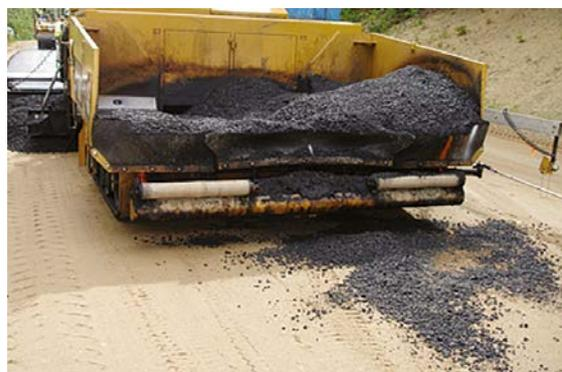
*La alineación incorrecta de camiones conduce a derrames de la tolva.*
