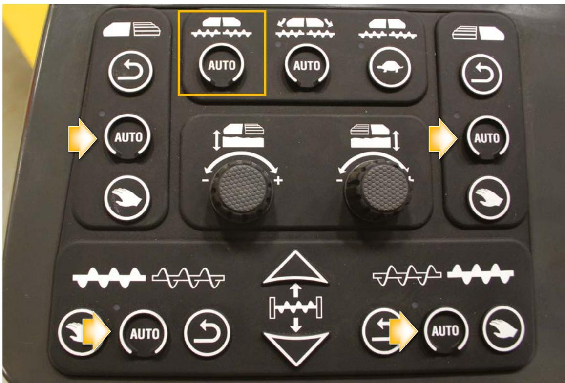
*Coloque los controles del alimentador en modo automático.*
